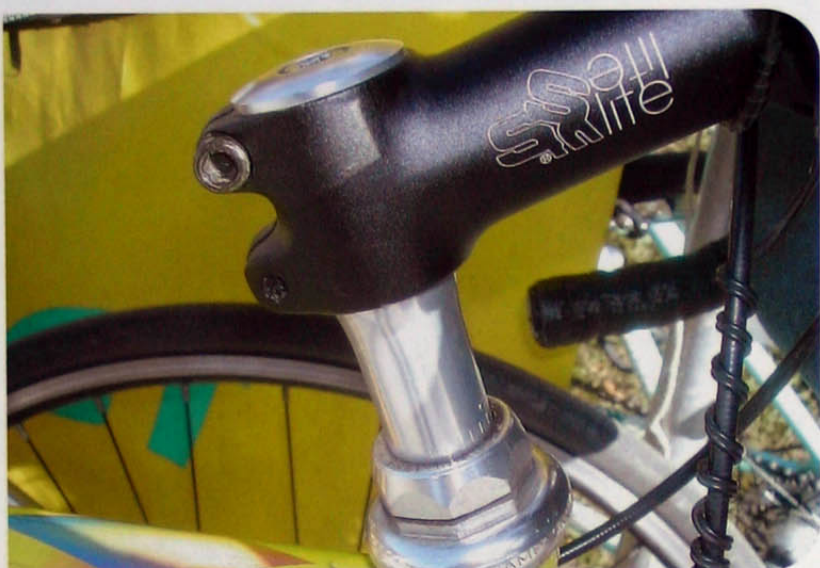
▲ Bonne combinaison ! Un plongeur réglable en hauteur et une potence Ahead-Set réversible !
