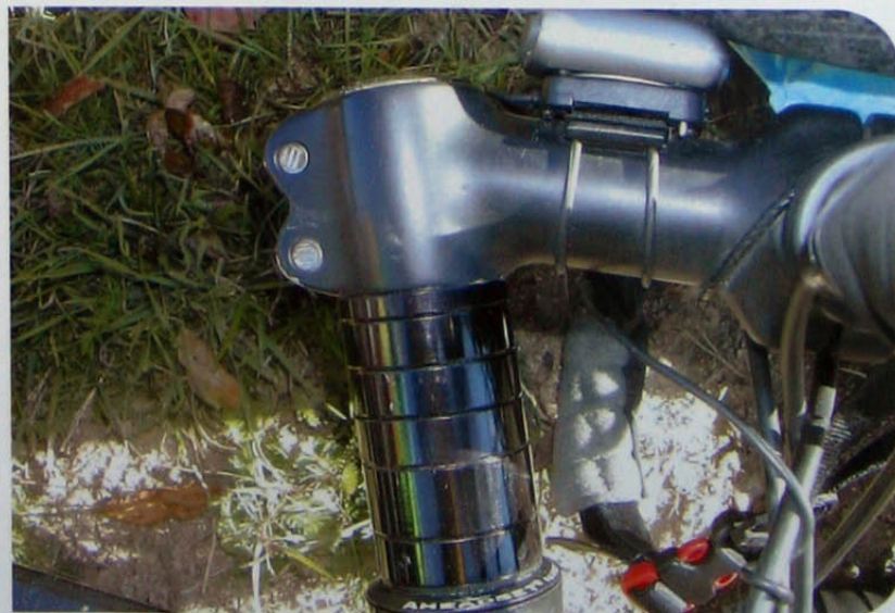
▼ Pas moins de 6 entretoises ont été nécessaires pour parvenir à la bonne hauteur ! Visiblement le cadre n'était pas "à la hauteur !".
