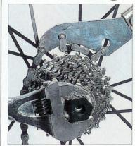
Le démontage s'effectue avec un fouet, ainsi qu'une clé permettant de desserrer la rondelle de la cassette. Les fouets "artisanaux" font très bien l'affaire. quelle que soit l'épaisseur des pignons, puisqu'il ne sert qu'à bloquer la roue libre. Il évite ainsi que lorsque l'on desserre l'écrou, elle tourne dans le vide...
