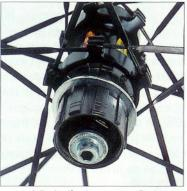
de positionner une rondelle derrière la cassette, afin de combler la différence d'épaisseur entre les cassettes dix vitesses Campagnolo et les neuf vitesses Shimano, ou autre...
