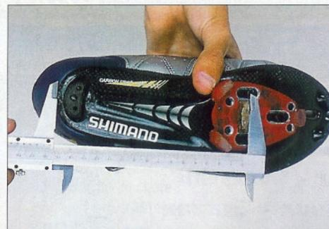
2 La particularité du système de cale Time tient dans le fait que la butée métallique dite de référence est fixée sur une plate-forme. La cote se prend donc de celle-ci jusqu'au talon de votre chaussure.
