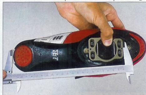
4 Pour les modèles Speedplay, hormis le réglage de profondeur qui peut se faire au calibre à coulisse, en haut ou en bas de la cale, il faut aussi tenir compte du déport latéral. Mesurez la cote latérale ou faites une marque.
