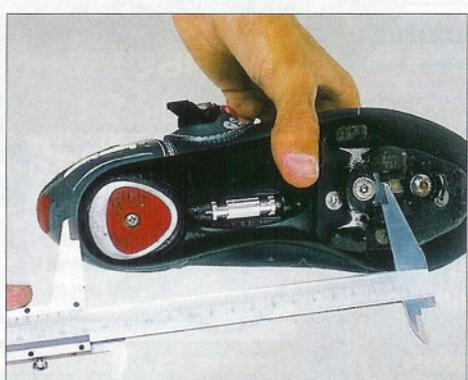
3 Avec ce système de cale deux points, l'ennui c'est qu'après avoir positionné la cale en profondeur, elle risque de bouger latéralement en raison des deux seuls points d'ancrage. L'idéal est de faire un repère.
