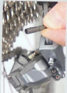
▲ Les connectiques doivent être en parfait état. Les traces de rouille au niveau des contacts pour les batteries ou d'oxydation sur les fiches sont sources de soucis. Changez celles-ci si vous avez un doute.
