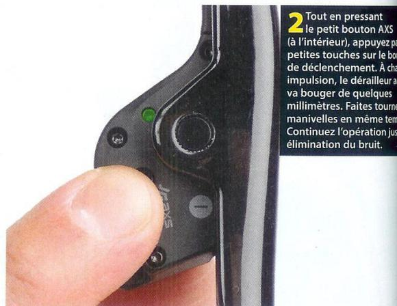
**2** Tout en pressant le petit bouton AXS (à l'intérieur), appuyez par petites touches sur le bouton de déclenchement. À chaque impulsion, le dérailleur avancera de quelques millimètres. Faites tourner manivelles en même temps. Continuez l'opération jusqu'à l'élimination du bruit.
